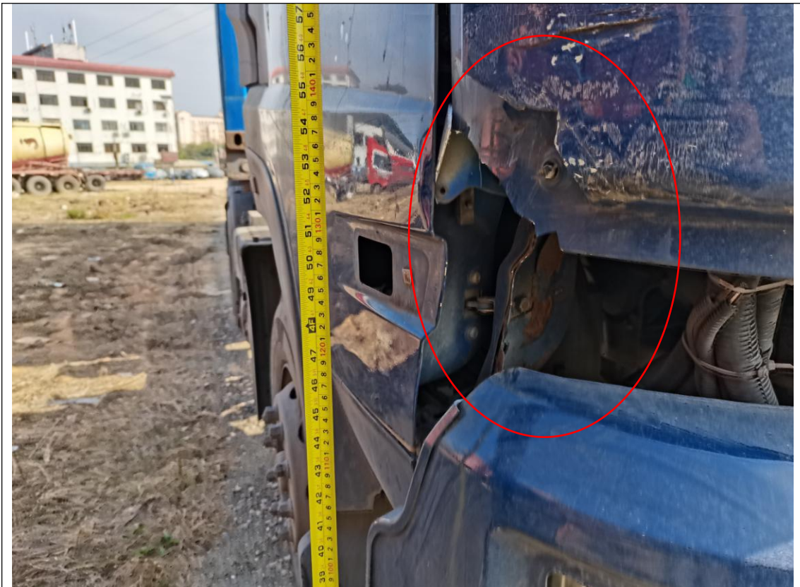
图二 涉事重型半挂牵引车右前角的碰撞痕迹
