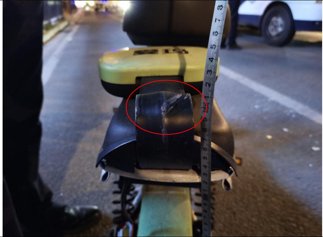
图四 涉事二轮电动自行车尾部的碰撞痕迹
